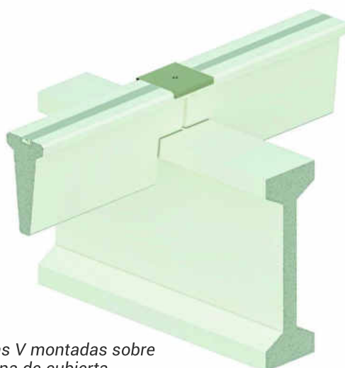
Apoyo de vigas T-18 / T-20 sobre jácena de cubierta
