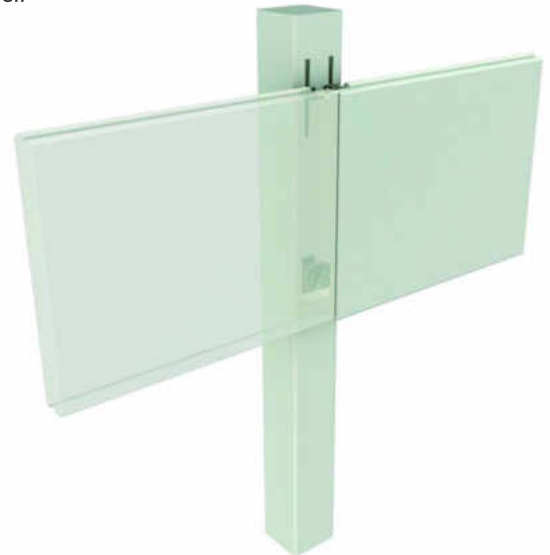
Detalle de pilar con panel colgado con guía de sujeción
