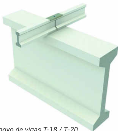
Apoyo de vigas T-18 / T-20 sobre jácena de cubierta
